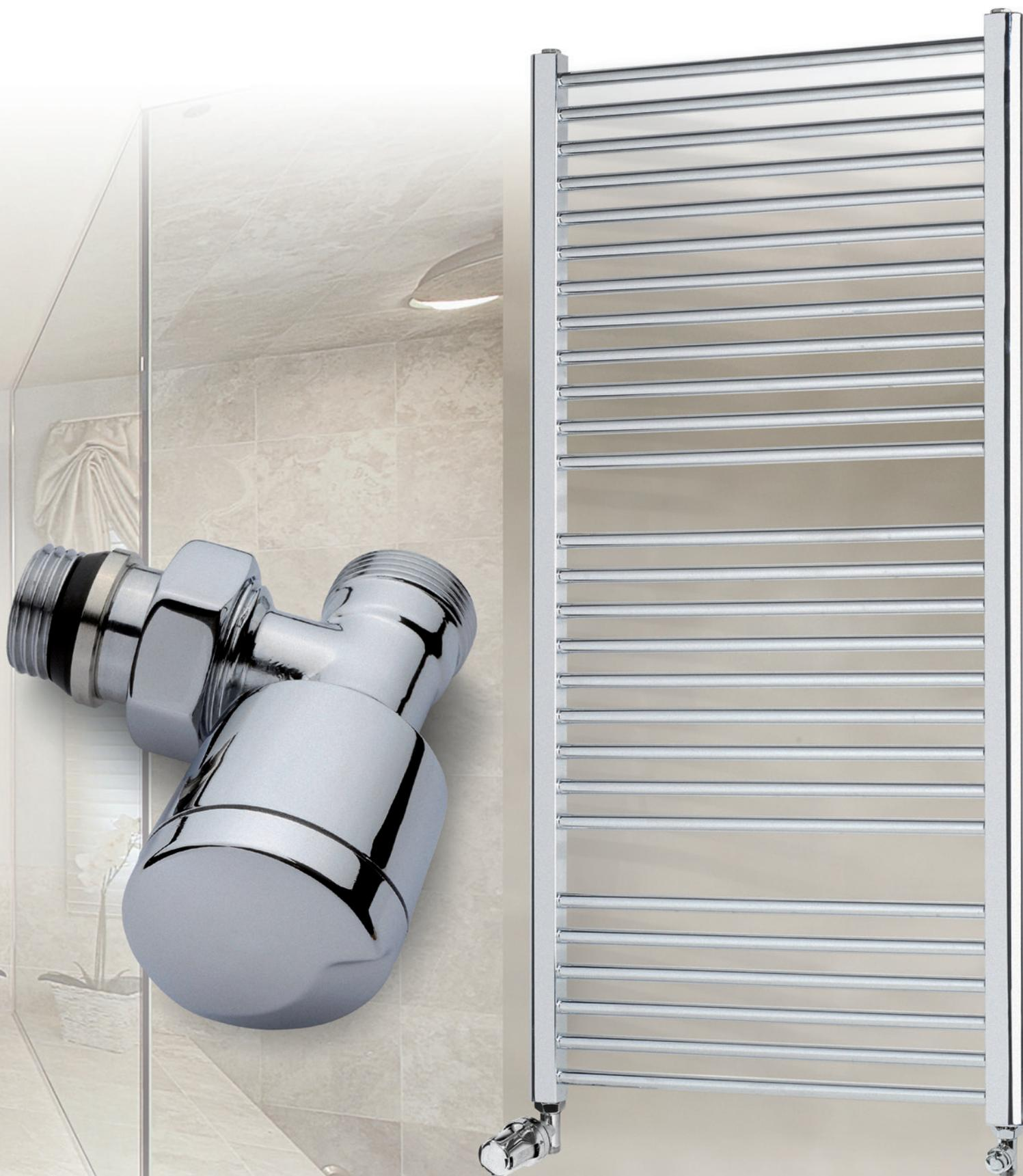
La linea IVR Thermochrome si compone di un kit valvola termostattizzabile con volantino manuale e detentore con bocchettone autotenuta. Il kit è disponibile nelle versioni squadra e diritto con attacco per tubo rame/multistrato e per tubo ferro. La testa termostatica Sunnychrome con sensore a liquido e gli adattatori per tubo rame e multistrato completano l'assortimento della linea.
