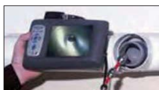
videoispezione di ogni sistema fumario
